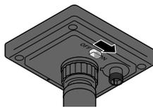
▷ Mettez l'interrupteur situé sur la face inférieure du module solaire en position **ON** pour activer la guirlande lumineuse.
