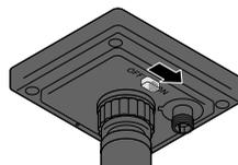
▷ Schieben Sie den Ein-/Aus-Schalter auf der Unterseite des Solarmoduls auf **ON**, um die Lichterkette zu aktivieren.
