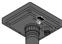
▷ Pour désactiver la guirlande lumineuse, mettez l'interrupteur situé sur la face inférieure du module solaire en position **OFF**.
